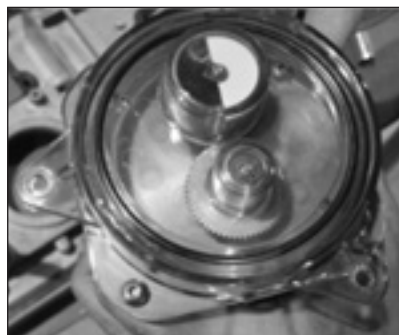
Figure 9.40 - Placez le joint torique sur le couvercle de la cartouche de couleur ambre
