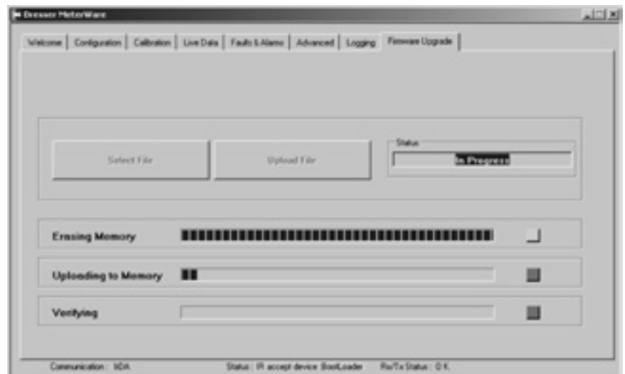
Figure 12.8 - Progression des trois étapes pour téléchargement du nouveau micrologiciel de l'appareil
