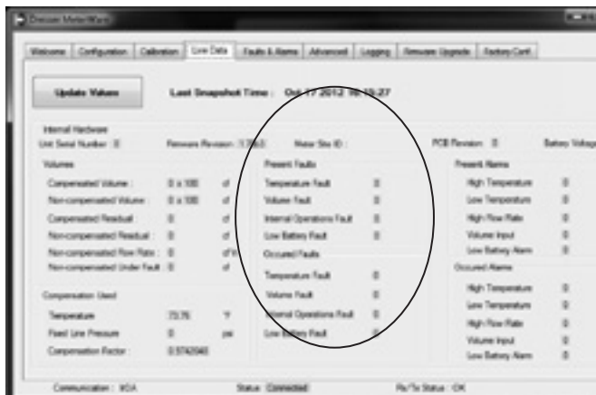
Figure 8.2 - Écran de données en direct montrant les Défaillances dans le logiciel MeterWare de Dresser
