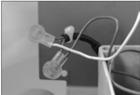
Figure 7.20 - Sortie 2 à impulsions câblée au ERT avec une attache de câble située près de l'extrémité de la gaine thermorétractible
