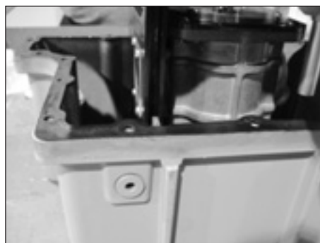
Figure 9.47 - Alignement des rainures du joint avec nervures
