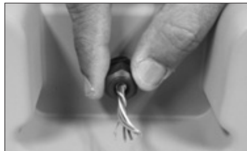
Figure 9.11 - Desserrez le connecteur de la goupille du câble
