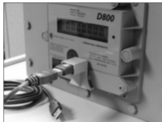
Figure 12.1 - Installation appropriée du câble IrDA du compteur
