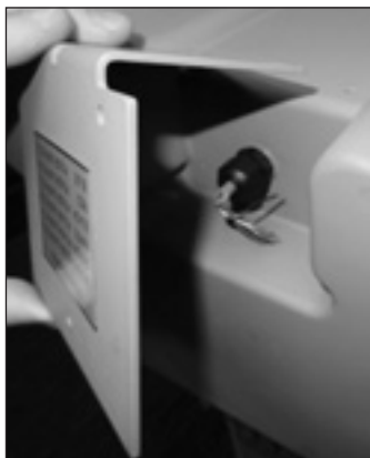
Figure 7.28 - Le câble de sortie à impulsions est couvert d'une plaque de protection
