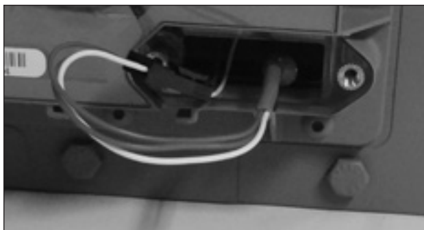
Figure 9.24 - Poussez la sonde de température dans la cavité de la sonde
