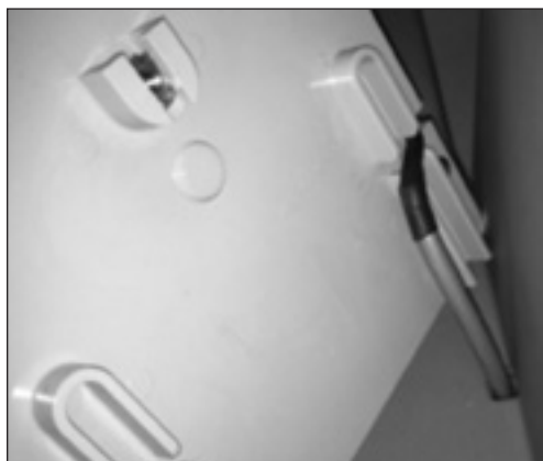
Figure 7.22 - Câble du compteur acheminé dans la plaque arrière
