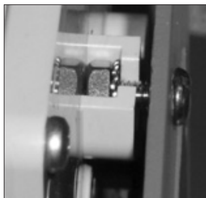
Figure 7.25 - Plaque de montage fixée à l'écrou
