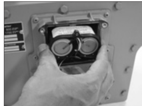
Figure 9.22 - Placez la batterie dans le compartiment
