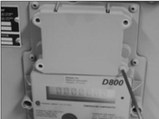
Figure 9.7 - Retirez les 4 vis du compartiment à batterie
