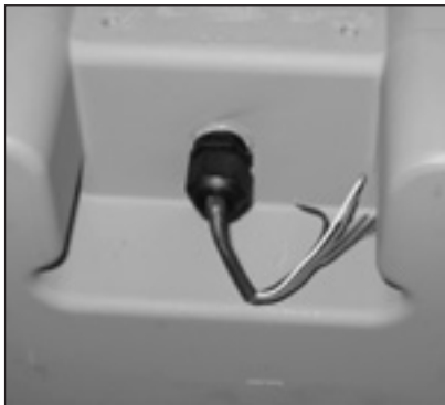
Figure 7.15 - Câble de sortie à impulsions du côté arrière du compteur
