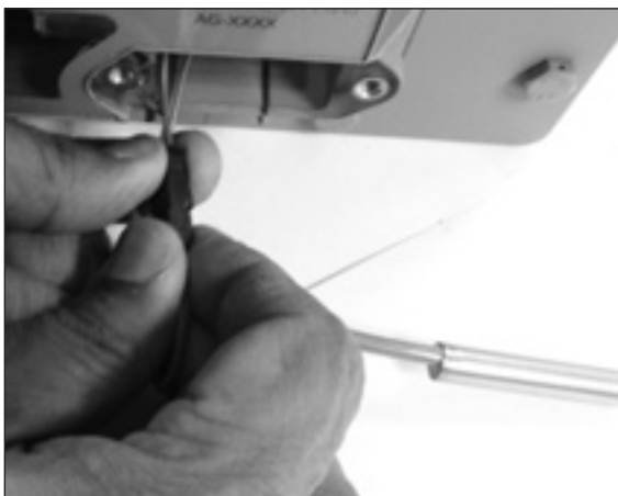
Figure 9.3 - Appuyez et relâchez le connecteur noir pour retirer la sonde de température
