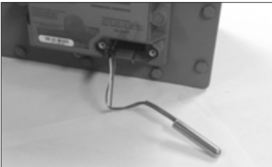
Figure 9.20 - Sonde de température prolongée par l'avant du couvercle de l'instrument.
