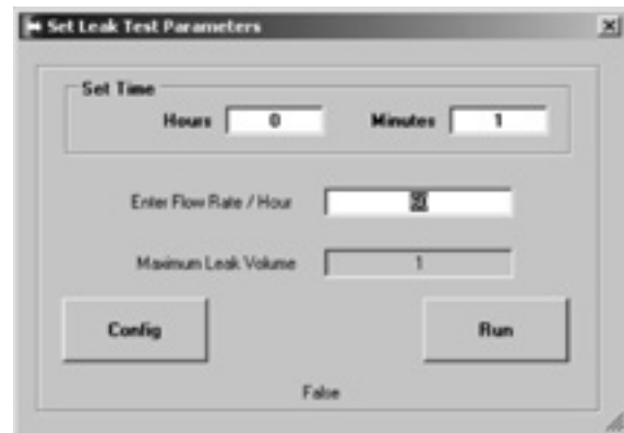
Figure 7.12 - Écran de configuration du logiciel MeterWare de Dresser pour l'essai d'étanchéité en aval
