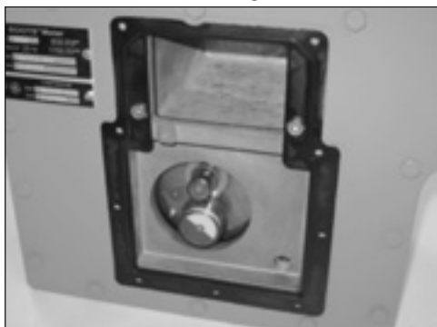
Figure 9.14 - Placez le joint sur le compteur
