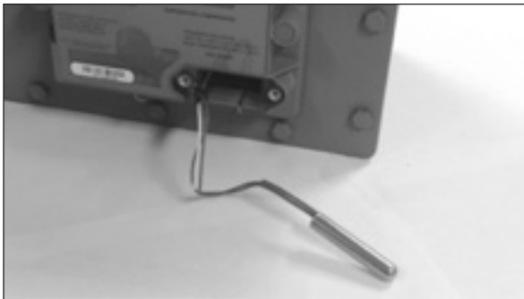
Figure 9.2 - Sonde de température retirée du compartiment
