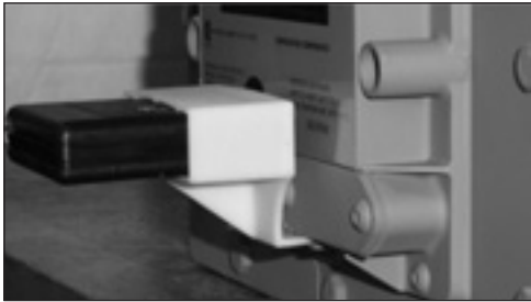
Figure 10.15 - Adaptateur IrDA placé dans la fente
