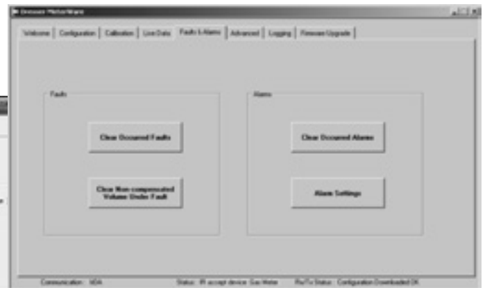
Figure 8.4 - Écran des défaillances et alarmes tel qu'affiché dans le logiciel MeterWare de Dresser
