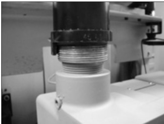
Figure 10.10 - Connexions SNAP correctement ajustées au compteur
