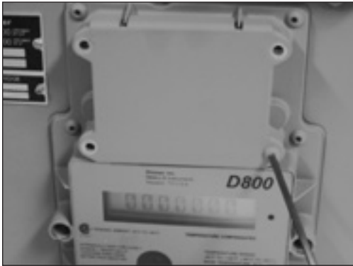
Figure 9.28 - Retirez les 4 vis du couvercle de la batterie
