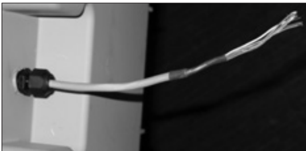
Figure 7.16 - Desserrez la goupille du câble et sortez le câble hors de la goupille
