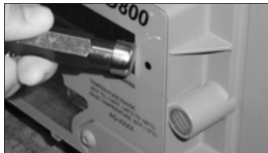
Figure 6.2 - Faites glisser l'aimant par le point noir pour modifier les écrans.
