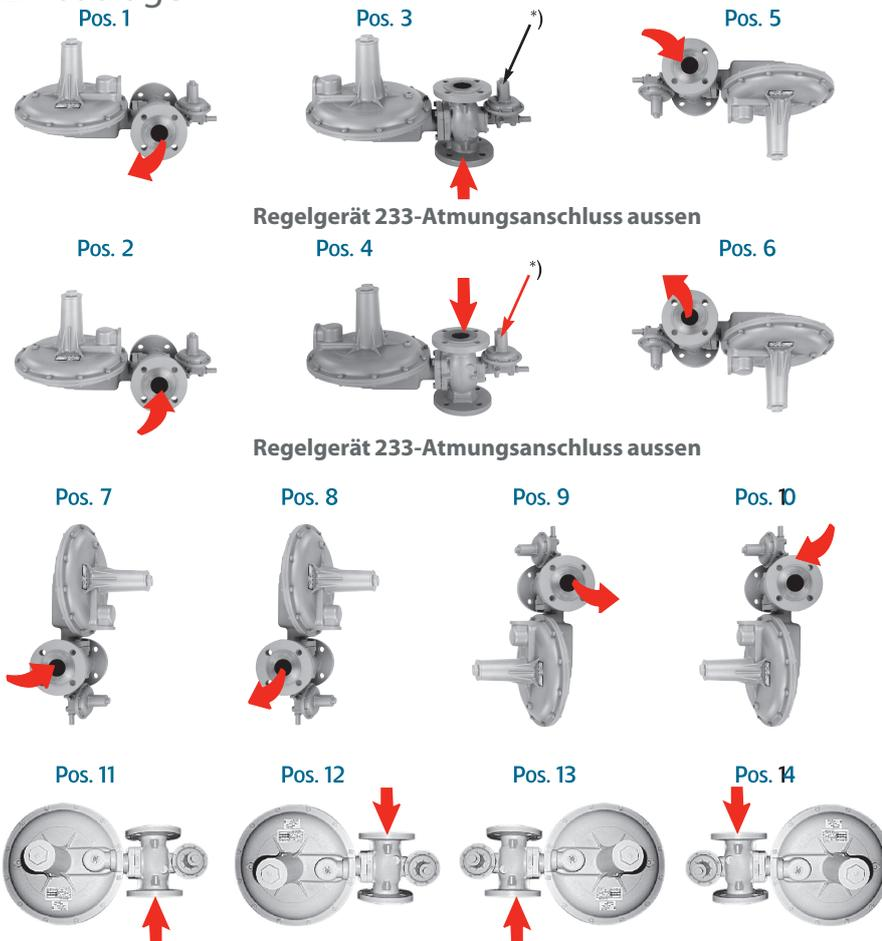
Gewünschte Einbaulage bitte bei Bestellung angeben. Wenn nicht anders angegeben, werden die Regler für den normalen Einbau (Pos. 2) montiert und eingestellt:
