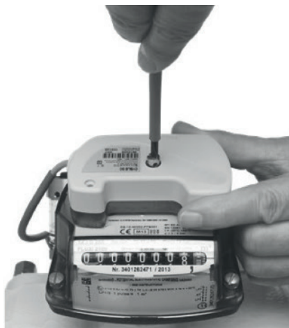
b) Fixierung (max. Drehmoment: 0,25 Nm)
